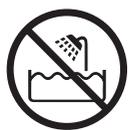
Ce symbole signifie que l'appareil ne doit pas être utilisé à proximité de baignoires, douches, lavabos ou autres réservoirs contenant de l'eau.
